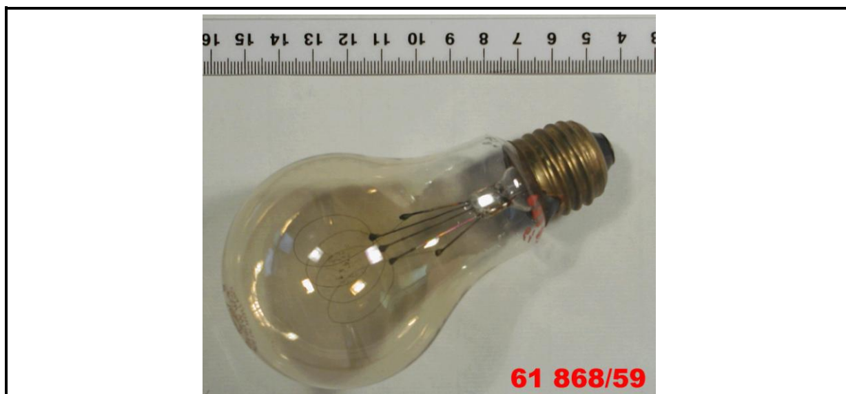
Obr. 5 - Žárovka s uhlíkovým vláknem stočeným do šroubovice se třemi a půl kruhovými závity o průměru cca 20 mm. Poloha vlákna v baňce je fixována pomocí 5 kovových (pravděpodobně Cu) vějířovitě zapíchnutých do stisku talířku. Obě krajní podpěrky (současně jsou to i přívody) jsou kratší (cca 22mm), tři vnitřní jsou nastaveny přivařením dalšího kousku drátu, takže jejich celková délka je cca 32 mm. Na konci každé podpěrky je vytvořeno očko, jímž prochází střední závity vlákna ve svém nejnižším bodě. Místa spojení jsou pokryta tmelem černé barvy. Přívody jsou trídílné, vnitřní část-Cu, zátavový drát-plášt'ový, vnější část-Cu. Zátav na talířek, pod jehož stiskem se nachází čerpací trubička. Baňka je hrušková, čirá, nažloutlá – od getru. Patice E27, mosazná, izolace- vitrit. Zátav je tvarovaný, zajišťuje lepší pevnost přitmelení patice k baňce. Na vrchlíku žárovky je kruhové razítko s nápisem Philips, 220-230V 60W, 16C.P.* c8 a tradiční firemní znak PHILIPS. El. a svět. parametry 220-230V, 60W. Vláknem je neporušené, žárovka je funkční. Rok výroby 1905-1910.
