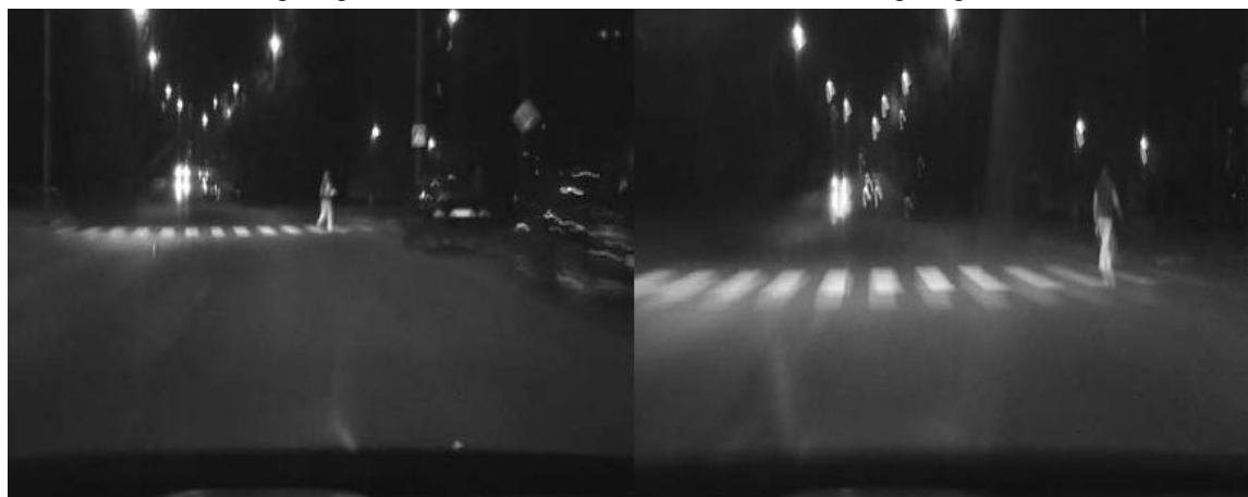
Obr 3. Přečhod osvětlený přečhod z obou stran 2 x 250 W
