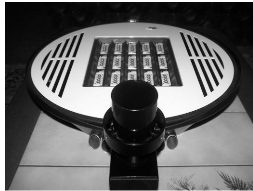
Obr. 1 První prototyp svítidla osazený 15-ti bloky LED, každý s příkonem 8W
